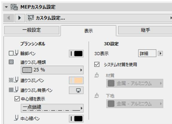
3D 表示またはレンダリングで使用される材質を調整する場合は、[システム材質を使用] チェックボックスをオンにして [システム材質] 設定の材質にすることができます。
