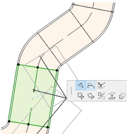
エッジ高度変更：2D ウィンドウでこのペットパレットコマンドを選択すると、[高度変更] ダイアログボックスが表示されます。選択した要素の変更する高度の値を入力します。
