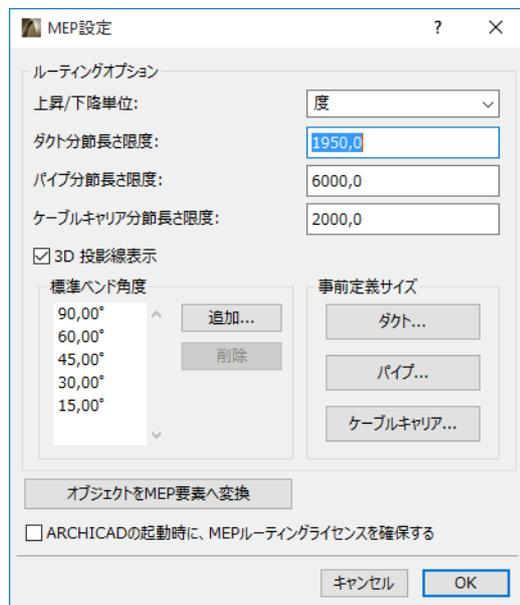
ARCHICAD の起動時に、MEP Modeler のライセンスを確保：このオプションを有効にすると、ARCHICAD を起動するたびに、プログラムで有効な MEP ライセンスを自動的に検索し、MEP 機能を有効にします。
