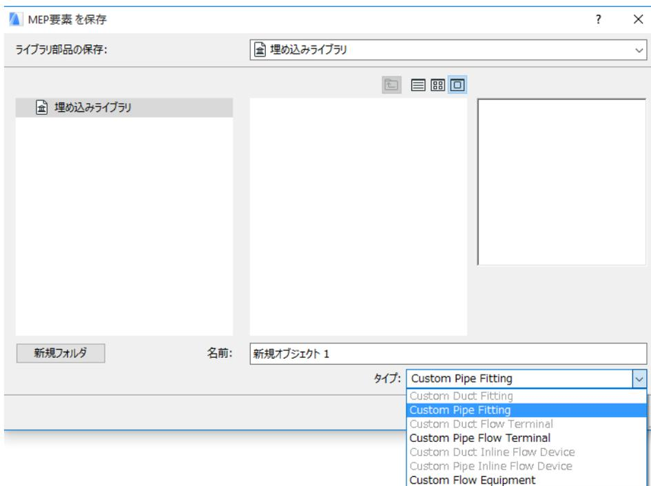
注記: このリストで使用可能なサブタイプは、カスタム MEP 部品に配置した MEP 接続オブジェクトの数とタイプによって決まります。カスタム MEP 部品に 1 つの接続のみの場合は、[ 機器 ] サブタイプと [ インライン ] サブタイプ (複数の共線接続が必要) は使用できません。また、[ 設定 ] ダイアログボックスで [ パイプ ] タイプに設定した MEP 接続を配置した場合は、[ ダクト ] サブタイプは使用できません。
