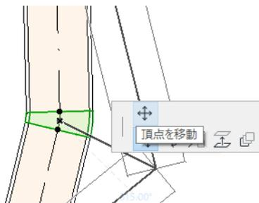
選択したベンドに加えて、それに接続される全ての直線要素（インライン、遷移、接合部要素を含む）に対して反映されます。選択したベンドの角度は変更され、必要に応じて新しいベンドが挿入されます。
