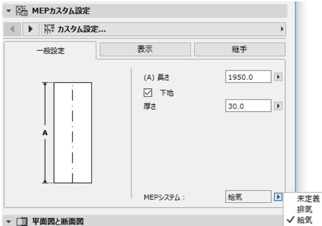
要素の接続が一般的に複数の目的 (温水 / 冷水システムに使用される炉など) で使用される場合は、その MEP システムの属性は [接続] タブページで各接続に個別に割り当てられます。
