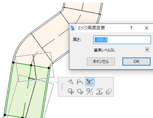
これは垂直編集のため、以前接続した直線セグメントの接続が切り離されても、平面図に結果のフィードバックが表示されません。ホットスポットが変更されます。
