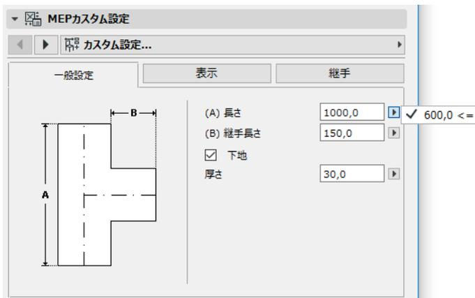
[断熱材]: 要素の外表面に断熱材層を含める場合は、このチェックボックスをオンにします。その後、断熱材の厚さの値を下のフィールドに入力します。
