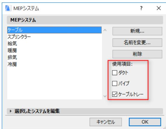
MEP システムを MEP ツールに割り当てる ([ ツールの設定 ] ダイアログボックスの [MEP カスタム設定] パネルを使用) と、この MEP システム設定によって使用可能な選択項目が決定されます。例えば、ある MEP システムをダクトタイプのツールに割り当てると、この MEP システムは [使用項目:ダクト] ポップアップリストで使用可能になります。
