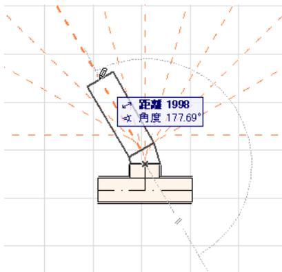
同様に、平面図でT型ダクトを配置する場合は、表示される参照線をクリックして次のルーティング要素を続行する角度を定義します。
