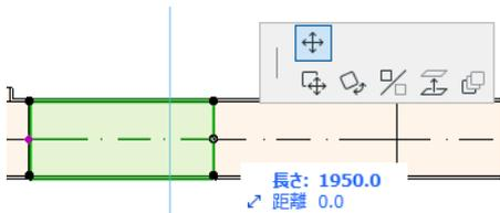
カーソルで接続節点をドラッグするか、または [座標情報] で値を入力します。これにより辺の長さが変更されます ([長さ] パラメータは要素の長さです。[距離] パラメータは節点を移動させた距離です)。
