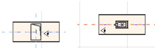
(Si vous aimeriez que l'élément placé suivant soit vertical, ne choisissez aucune des quatre directions horizontales indiquées par le retour visuel à l'écran. Changez la Méthode de construction (en utilisant la palette Cheminement MEP ou l'Inspecteur) en Élévation verticale et placez l'élément suivant.)
